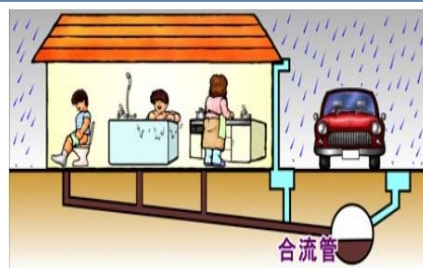
合流式下水道 (雨の日に汚水の混じった雨水が流れてしまう)
